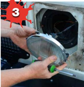
▲ Zuerst wird die Verkleidung samt Blinker und Standlicht abgebaut.
