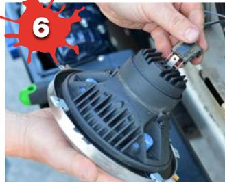
▲ Den Stecker verbinden und den Scheinwerfer in die Halterung setzen.
